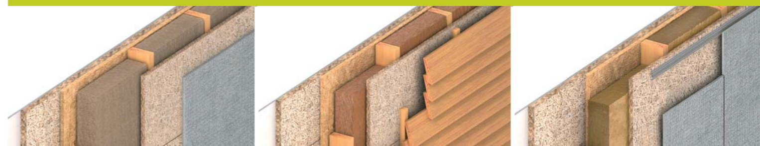
ISOLAMENTO ECOBIOCOMPATIBILE IN LANA DI LEGNO DI ABETE E CEMENTO PORTLAND
